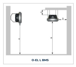
De série : Structure métallique laquée. Grille de soufflage avec ailettes réglables. Orientation sur le support de+85° / -85°. Sécurités de surchauffe. Compatible avec le système global BMS FLOWAIR.
