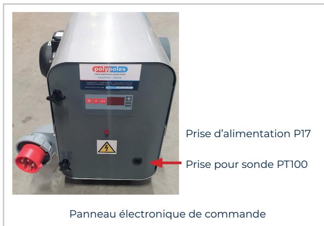
De série : Résistances blindées tubulaires en acier inoxydable. Caisson de chauffe isolé. Structure métallique laquée. Prise P17 incluse. Sécurité de surchauffe à réarmement manuel. Post-ventilation de refroidissement automatique. Pilotage électronique par sonde PT100 déportée.
