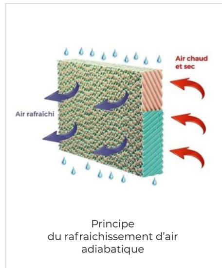
Avantages : faible coût d'installation, d'utilisation et d'entretien. Ecologique, consommation de 380W et 11 litres d'eau par heure. Fonction "ION" pour ioniser et purifier l'air. Fonction "SWING" pour balayage horizontal de la ventilation. Alimentation en eau manuelle ou automatique. Purge manuelle.
